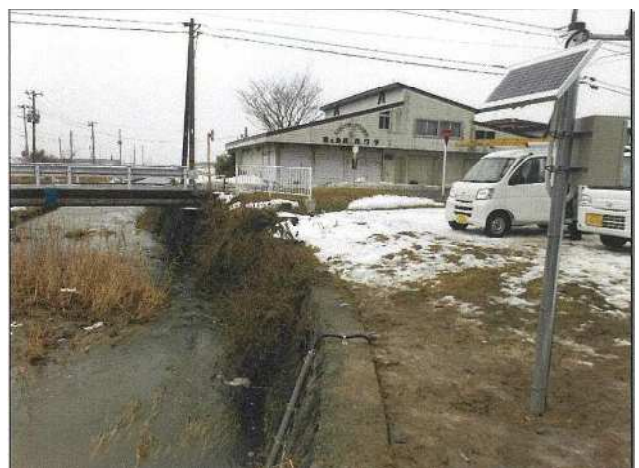
系流川 三種町鹿渡(浜村橋上流右岸) 【水圧式水位計】
